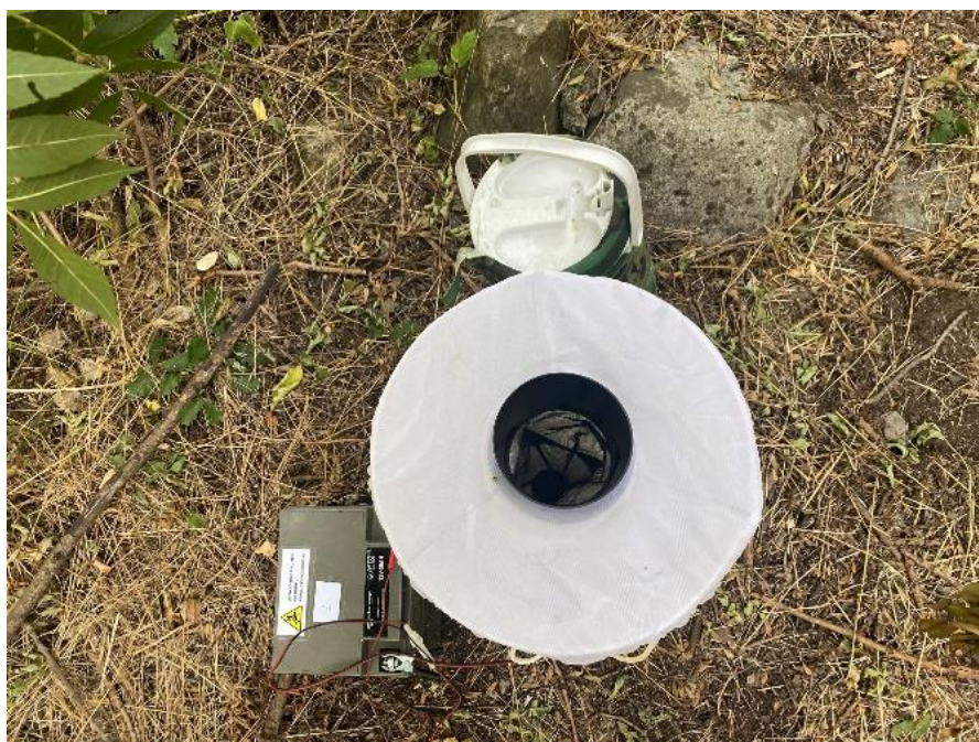
Fotografia 1: Trampa Biogents Sentinel 2 trap amb la bateria i la nevera plena de gel-sec. AR+I.
